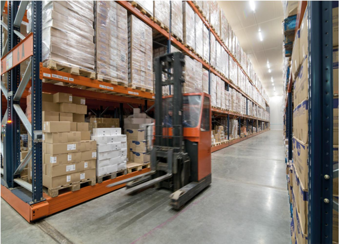
Las estanterías sobre bases móviles están dotadas de elementos de traslación, equipos electrónicos y dispositivos de seguridad para proteger a los operarios y la mercancía almacenada
