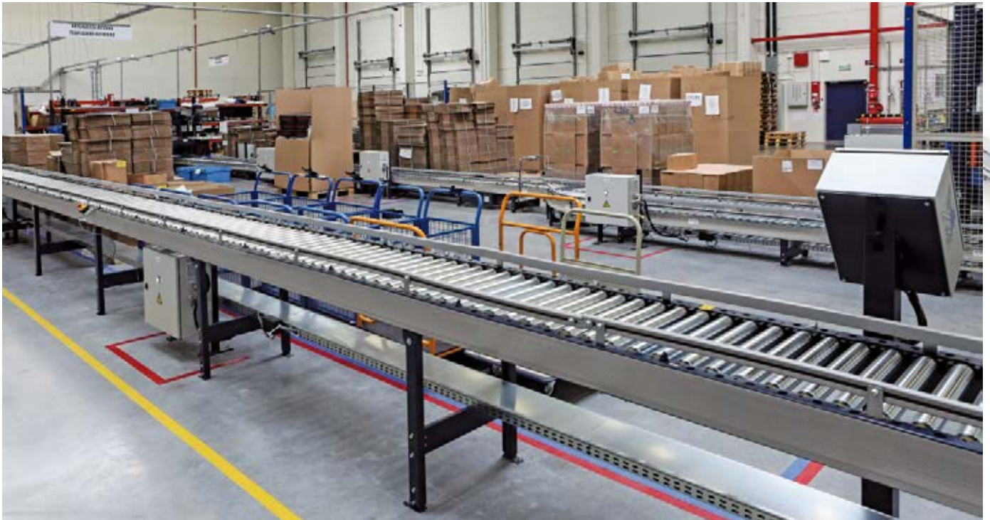
Las cajas llegan a los puestos de picking mediante un circuito de transportadores que mide más de 38 m de largo
