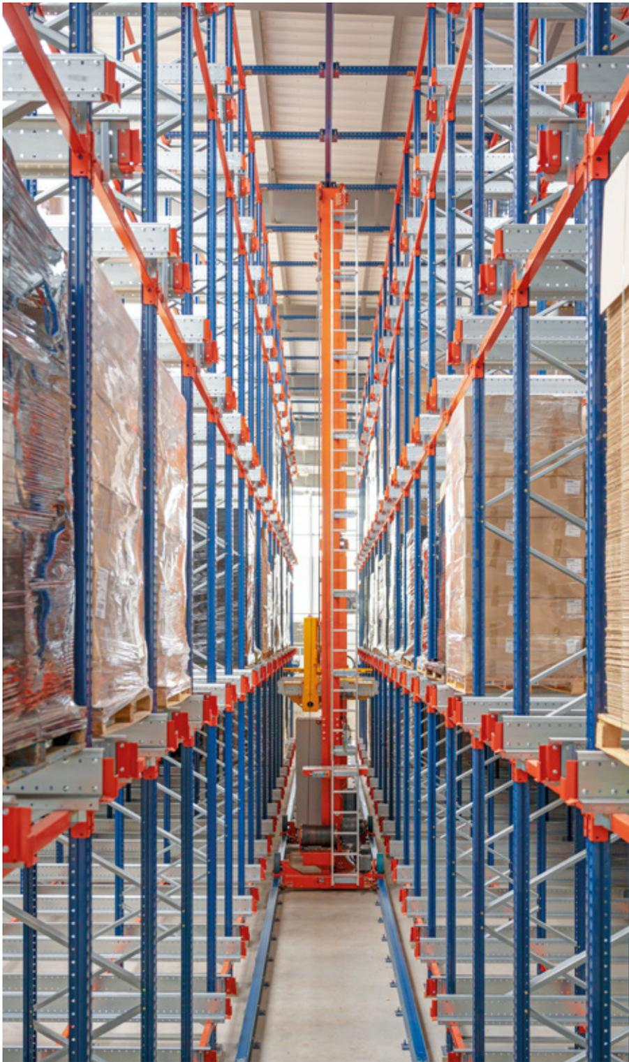
de huecos vacíos, la referencia y el nivel de demanda para asignar una ubicación dentro de las estanterías. Es entonces cuando interviene la robotización y, mediante transportadores, el transelevador y el carro Pallet Shuttle, se encargan de trasladar automáticamente el palet hasta la ubicación correspondiente.
