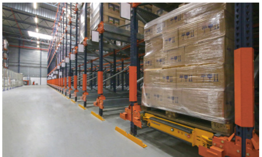
El transportador mide 42 m de longitud y se desplaza a una velocidad de 10 m/min
